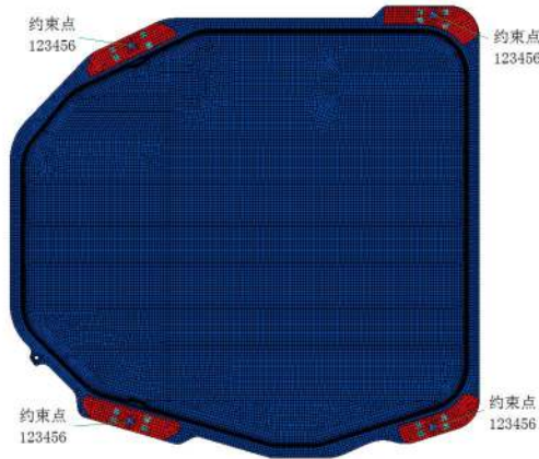
图1 燃油箱原始概念有限元模型
